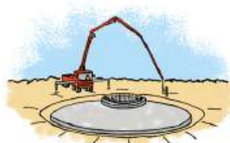
Bétonnage de la fondation
